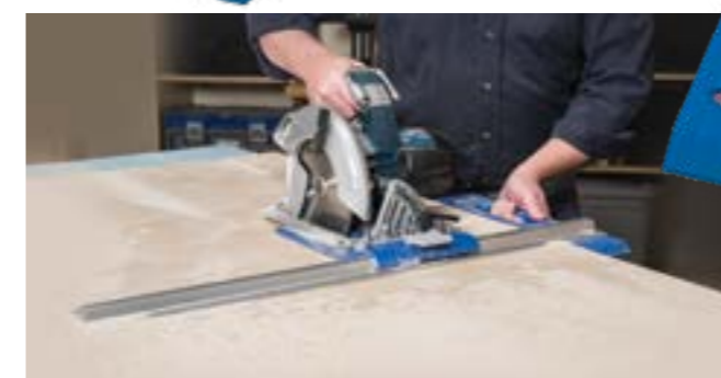
Het is niet nodig om te meten of te markeren, dankzij de ingebouwde meetlat en precisiecursor. Stel gewoon de zaagbreedte in en u bent klaar om te zagen.
