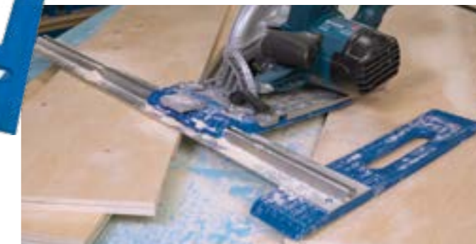
U kunt makkelijk meerdere stukken met dezelfde afmeting maken, zonder fouten door vergissingen tijdens het meten.
