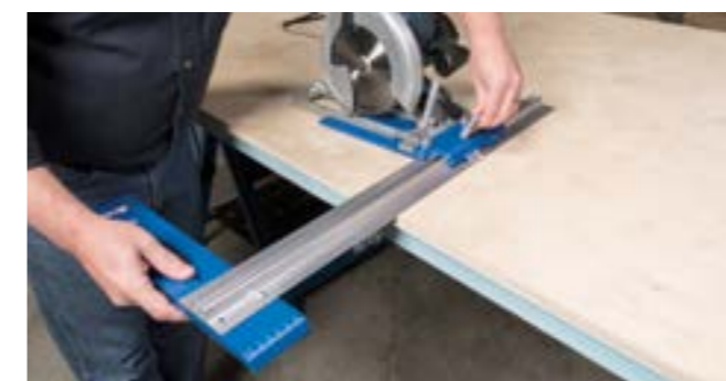
Verschuif de zaagslede langs de rail en blokkeer hem om snel en nauwkeurig af te stellen. Daar hebt u geen gereedschap voor nodig. De slede is ook compatibel met Accu-Cut™.
