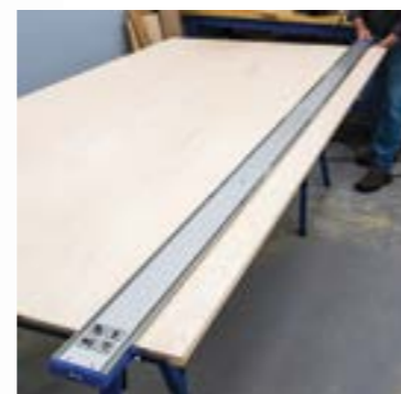
Maak uw aanslagliniaal 610 mm langer om plaatmateriaal af te korten of te schulpen.
