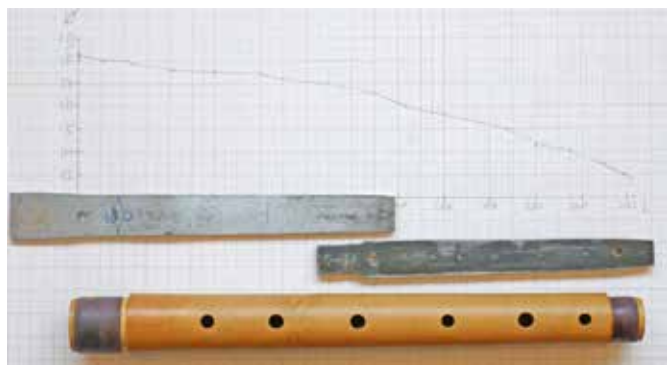
Altblokfluit, grafiek van de boring, twee van platstaal gemaakte ruimers.
