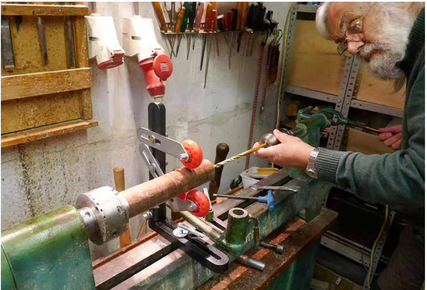
Hout boren op de draaibank (proefopstelling).
