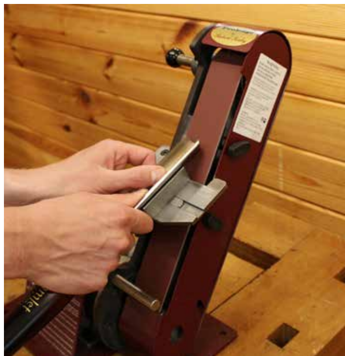
Houtdraaibeitel slijpen op de Sorby Pro-Edge bandslijpmachine.
