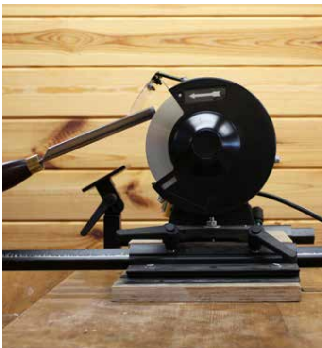
Slijpen van een houtdraaibeitel op een CBN-slijpsteen.
