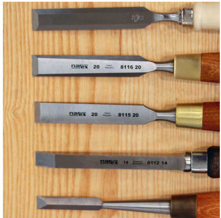
Van boven naar beneden: steekbeitel, steekbeitel, hakbeitel, schietbeitel, zwaluwstaartbeitel.
