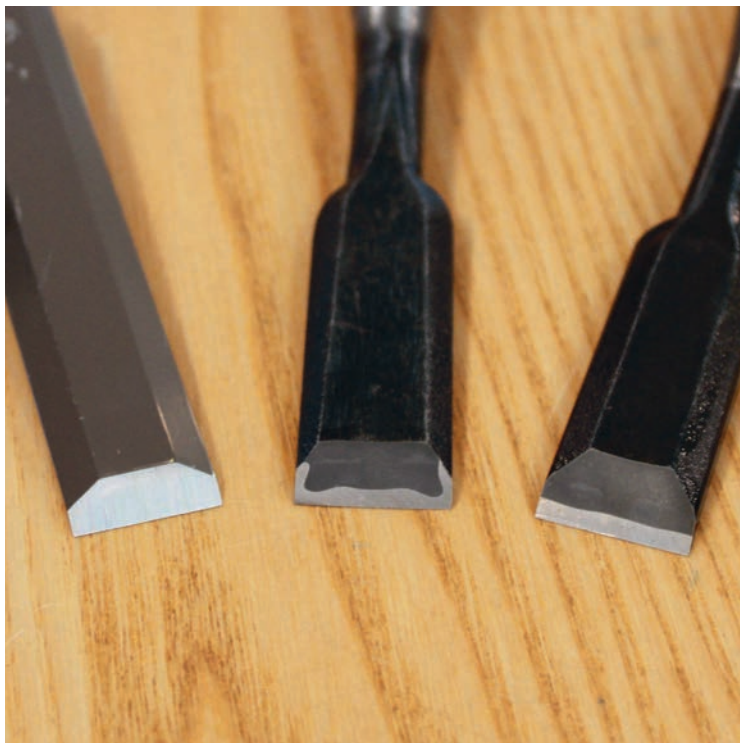
Westerse beitel uit één staalsoort (links) en twee Japanse beitels uit twee lagen staal. Ingekapseld (midden) en op elkaar (rechts).
