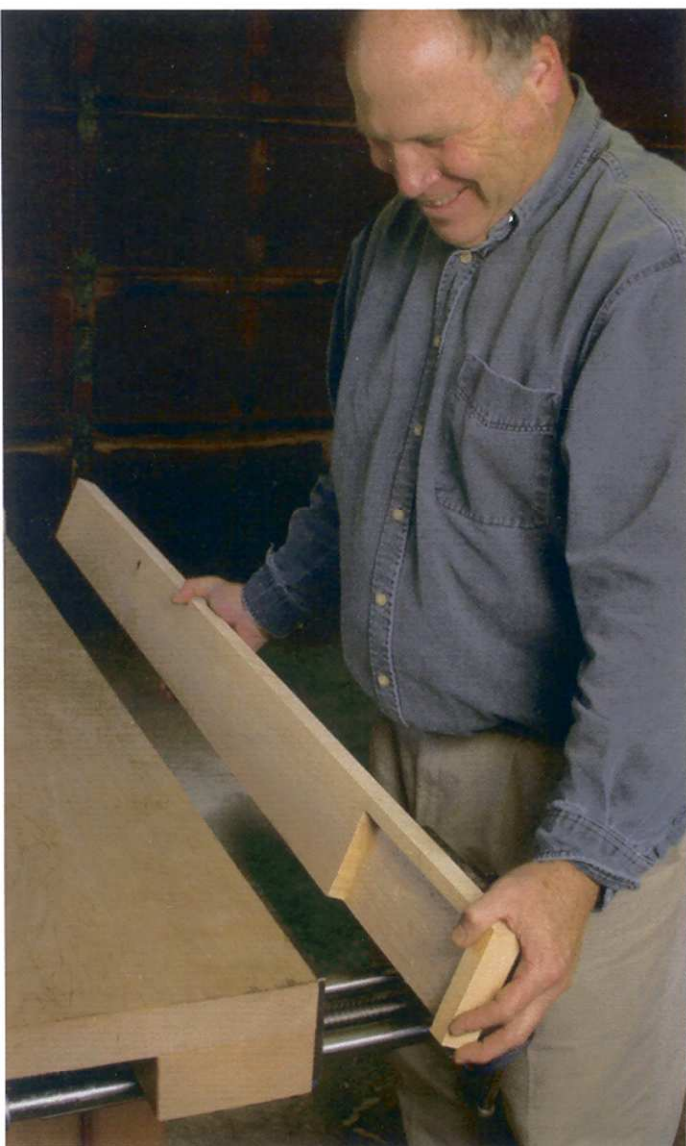
Een lang hulpstuk. Een inkeping in hulpstuk valt gelijk met de werkbankklem. Door het hulpstuk dezelfde lengte te geven als de werkbank is het mogelijk lange lengtes te klemmen.
