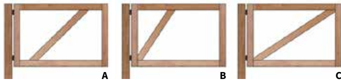
Deze drie tekeningen naast elkaar vormen straks figuur 3A, B en C : drie manieren om een schoor in een tuinhok te maken. De rechter manier ( C ) geeft de meeste stevigheid.
