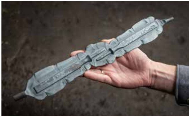
Het resultaat in het staal na het slaan van de smeedhamer.
