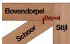
Figuur 5: op deze manier krijg je een sterke hoekverbinding die niet uit elkaar wordt geduwd.
