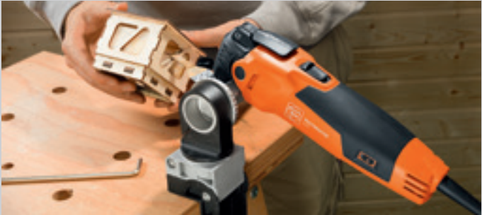
Eenvoudig inspannen op de tafel of werkbank voor perfect precisiezaagwerk.
